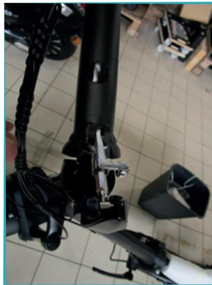
Déverrouillez le blocage guidon (levez la petite boule chromée) afin d'ouvrir le système de pliage du guidon.
