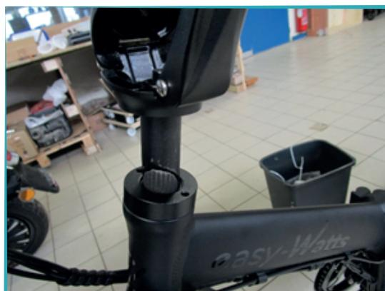
Desserez légèrement la vis de serrage et insérez le guidon dans le tube.
